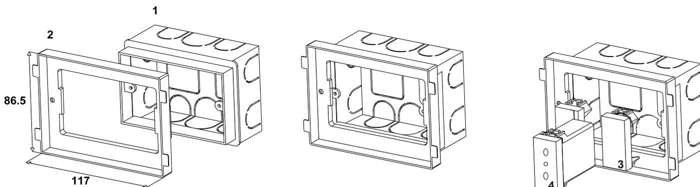
Posizionare la scatola 3 o 4 moduli nell'apposita scanalatura che si trova nel retro del distanziale D503 o 504 e fare pressione per il serraggio.
